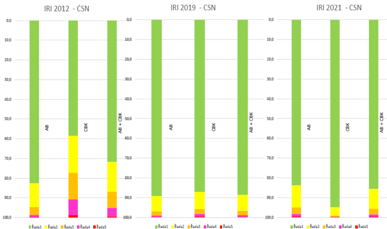
Obrázek 1 – Rozložení procent délky podélných nerovností IRI v jednotlivých klasifikačních stupních stanovených v ČSN 73 6175 v letech měření 2012, 2019 a 2021
